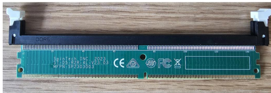
TEE.failにおけるDIMMライザー[2]。 DIMM（緑色の基板）が差さっている状態。
